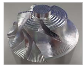
Bruch während der Bearbeitung
